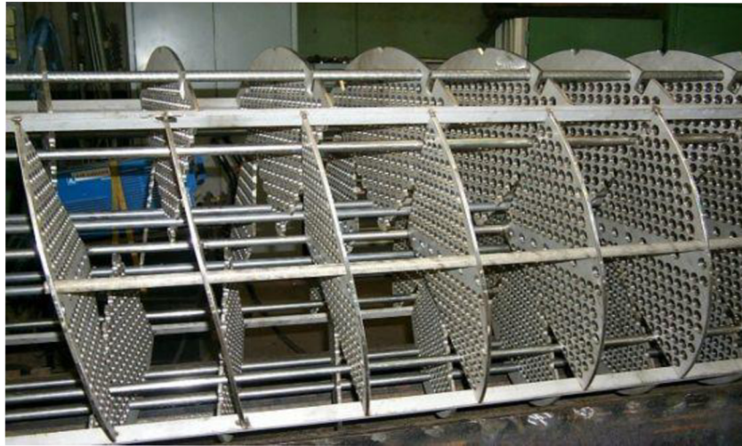
Obr. 10 – Přepážky ve výměnících tepla [8]
