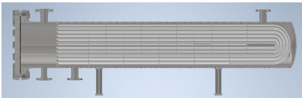
Obr. 27 – Model výměníku v řezu
