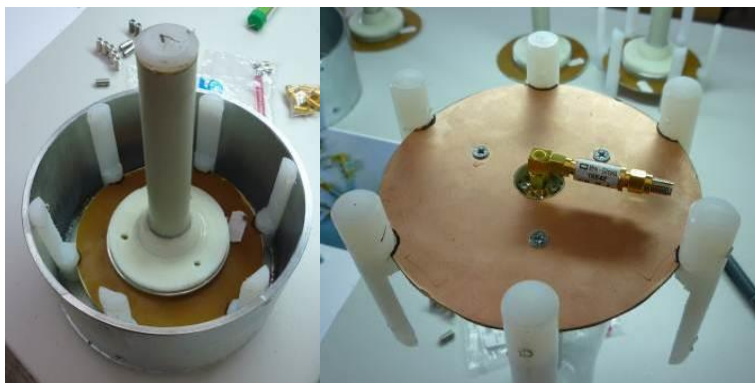
Obrázek 6.14 Konstrukce senzoru s izolovaným krytem.
