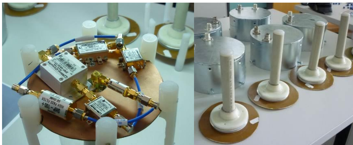
Obrázek 6.18 Konstrukční řešení základního provedení senzoru.
