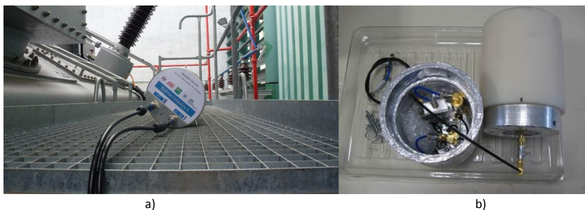
Obrázek 8.10 Umístění standardního senzoru na lávce transformátoru při testech metody diskriminace rušených akvizic a), konstrukce externího senzoru s dielektrickým krytem antény b).
