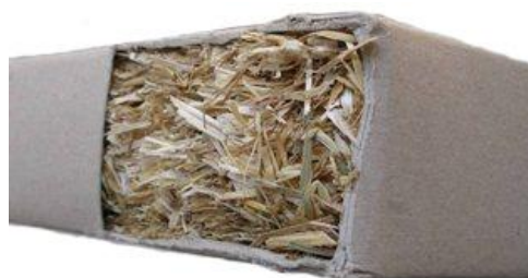
Obr. č. 11: Vzhled vnitřku panelu ze slaměných vláken tuzemské produkce (Štastník a kol., 2006)
