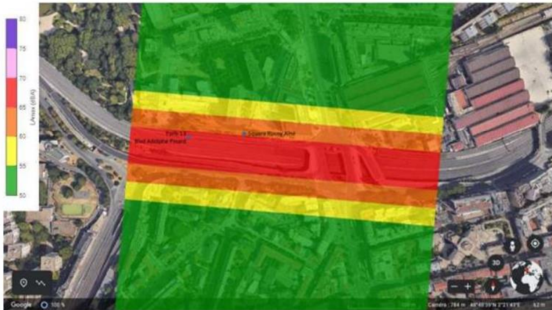
Figure 7 : Impact sonore maximal au passage (L Amax ), au sol, du VC-2X en phase de survol sur une portion du périphérique -source : dossier
