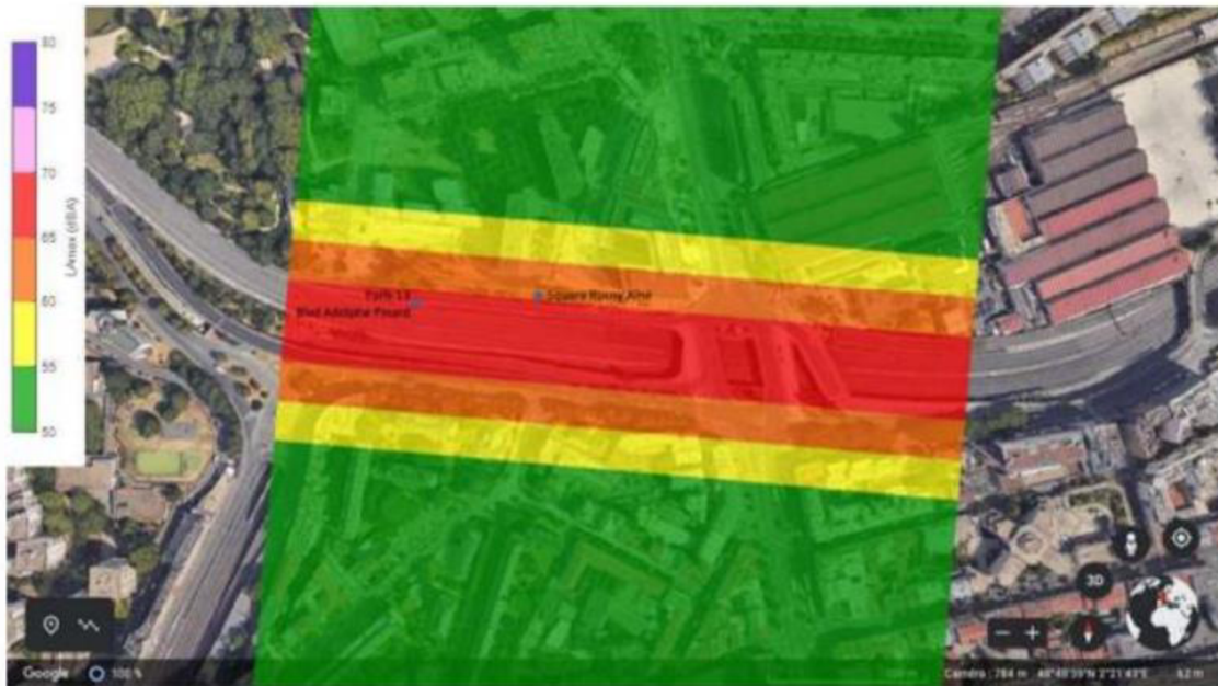
Figure 7 : Impact sonore maximal au passage (L max ), au sol, du VC-2X en phase de survol sur une portion du périphérique –source : dossier
