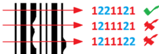
Obrázek 1 Správné a chybné čtení 1D kódu (Pharmacode 177) – zdroj autor
