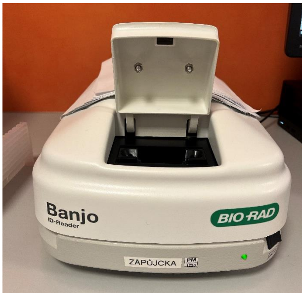
Obrázek č. 7 – Příklad BANJO ID-Reader – přístroj, který načítá výsledky ze zcentrifugovaných gelových ID karet a přenáší je do PC; zdroj: vlastní
