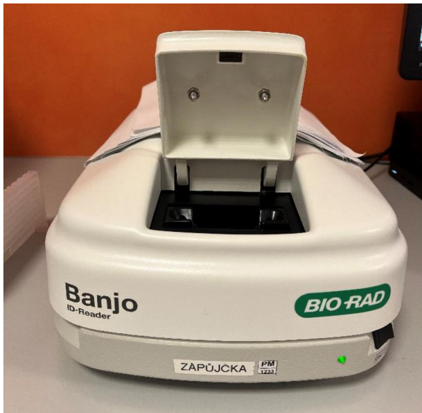
Obrázek č. 7 – Příklad BANJO ID-Reader – přístroj, který načítá výsledky ze zcentrifugovaných gelových ID karet a přenáší je do PC; zdroj: vlastní
