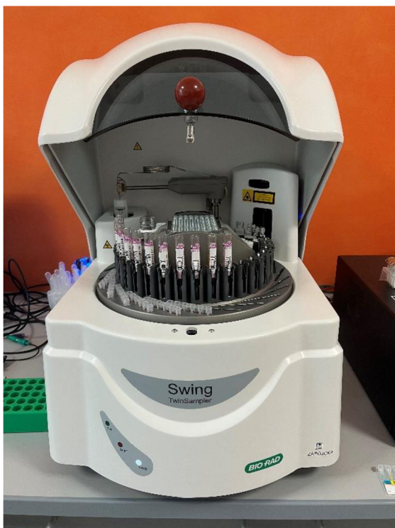
Obrázek č. 5 – Přístroj SWING II – přístroj, který rozpipetovává krev a plazmu dárce do ID karet; zdroj: vlastní
