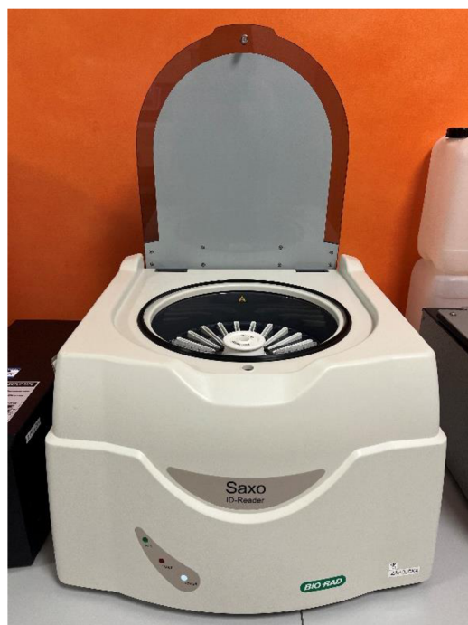
Obrázek č. 6 – Přístroj SAXO ID-Reader – přístroj napipetované ID karty centrifuguje; zdroj: vlastní
