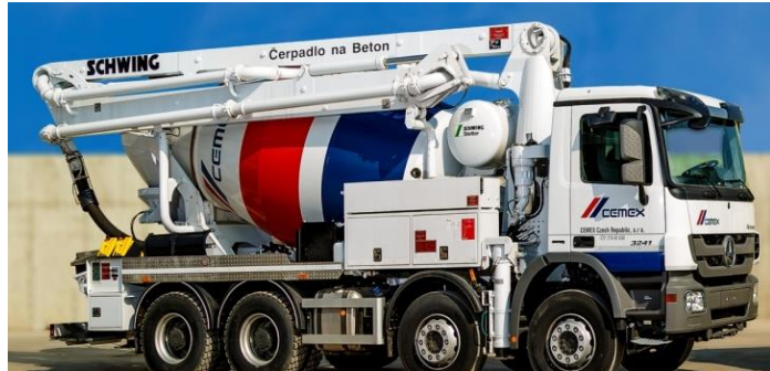
Obrázek 43 - Mobilní čerpadlo betonu CEMEX, výložník 39 m [19]
