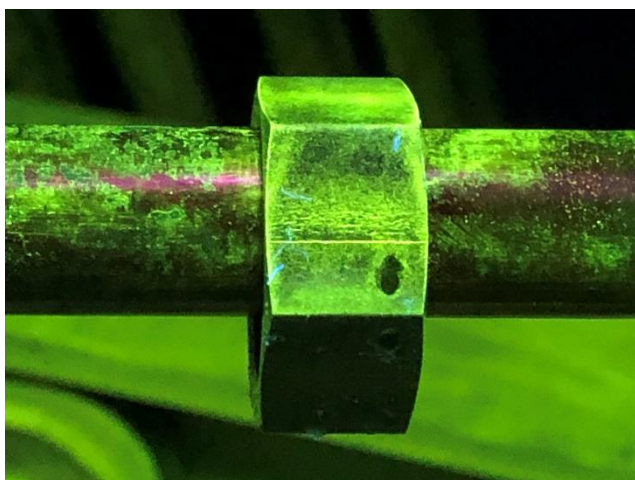
Obr. 29 Lineární indikace - Magnetická metoda
