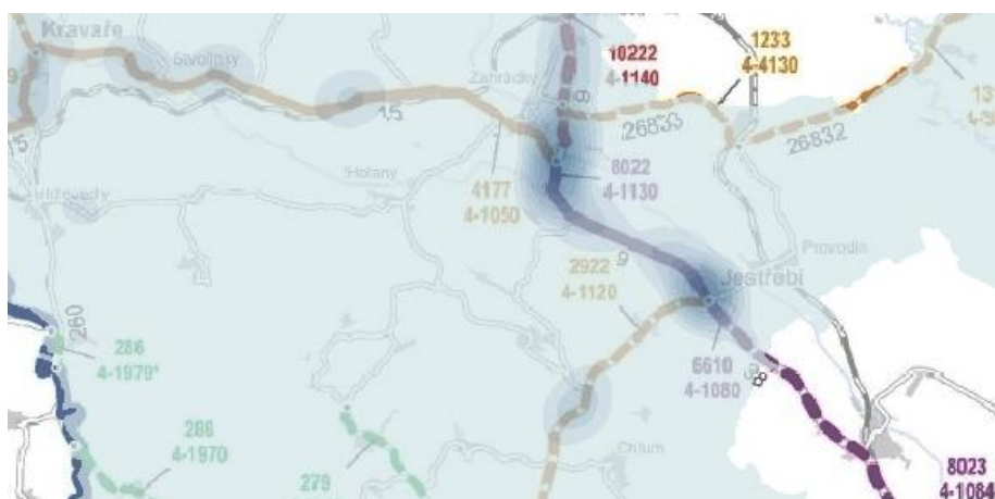
Obr. 36: Vizuální analýza: nebezpečí zatáček o malém poloměru v rovinných úsecích (zdroj: autor)
