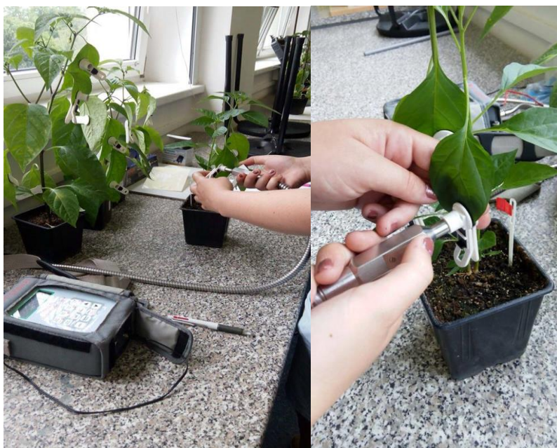
Obr. č. 5.- Měření fluorescence chlorofylu
