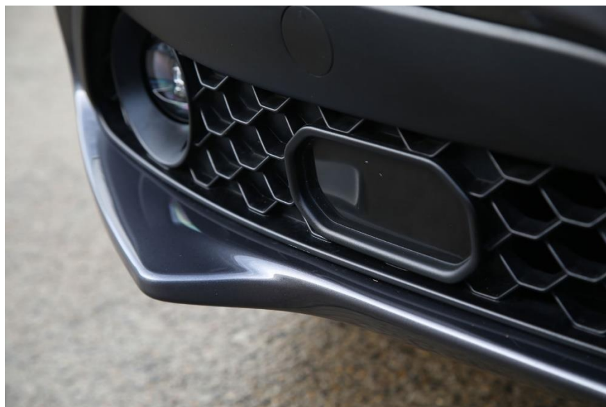
Obrázek 4: Montáž radarového snímače Bosch do mřížky předního nárazníku (Alfa Romeo Stelvio) [24]
