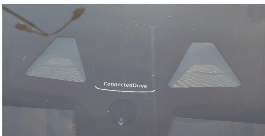
Obrázek 25: Stereokamera, BMW F90 [zdroj: vlastní]
