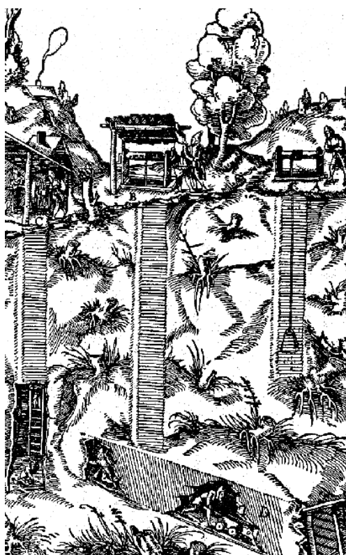
Obr. 1: Dřevoryty zachycující práce spojené s hornickou činností. Proplavování zlatonosného materiálu pomocí splavu, technika sázení ohněm, ražení šachet a štol a použití zlatorudného mlýna (Ježek – Hummel 1974, 82, 92, 253, 289).
