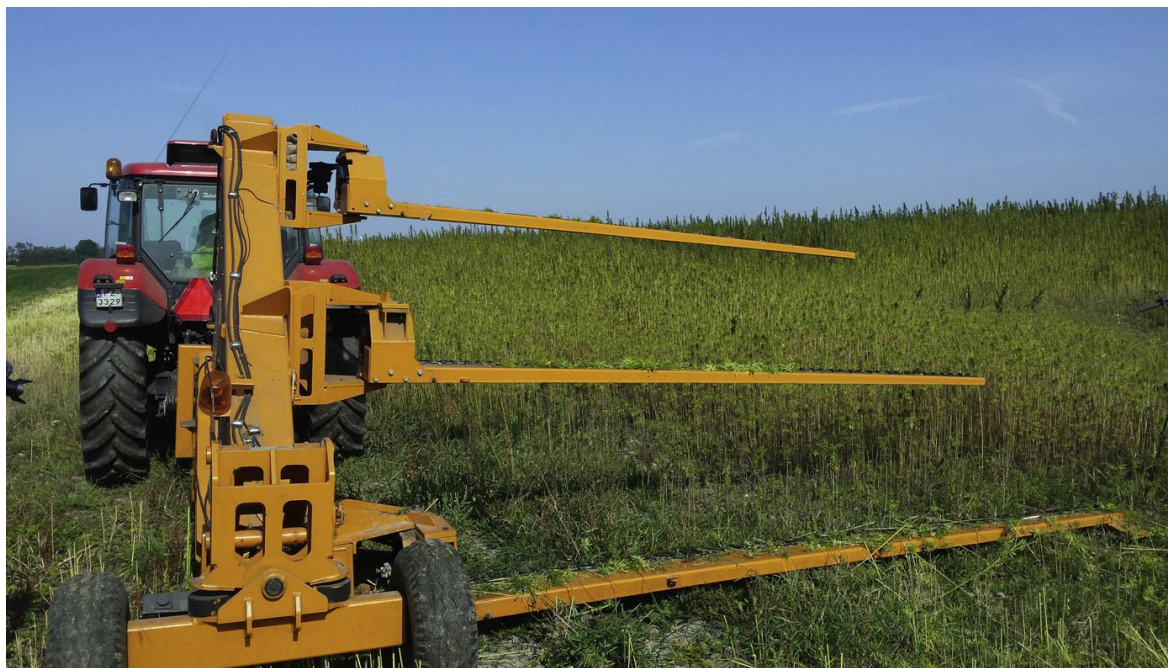
Obrázek 12 Český stroj pro sklizení přadných rostlin (Upraveno: Pari et al., 2014)
