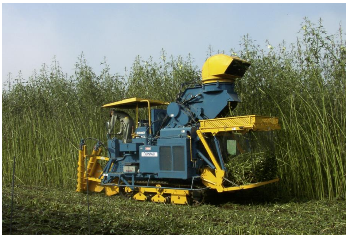
Obrázek 13 Sklízecí stroj na cukrovou třtinu (Upraveno: Pari et al. , 2014)
