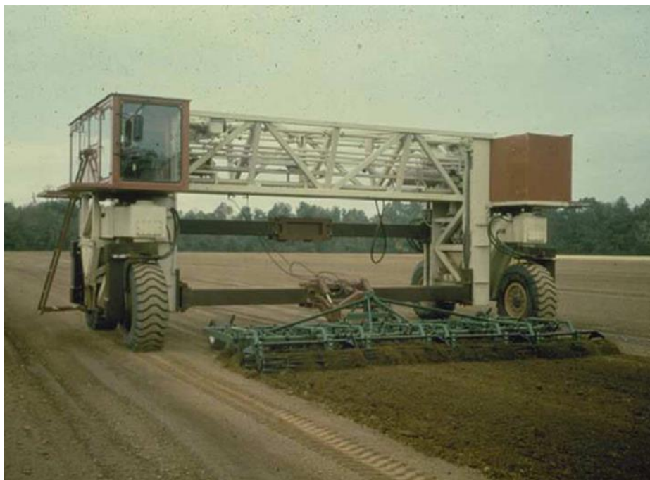
Obrázek 2 Prototyp traktoru s širokou roztečí kol (Upraveno: Raper, 2005)
