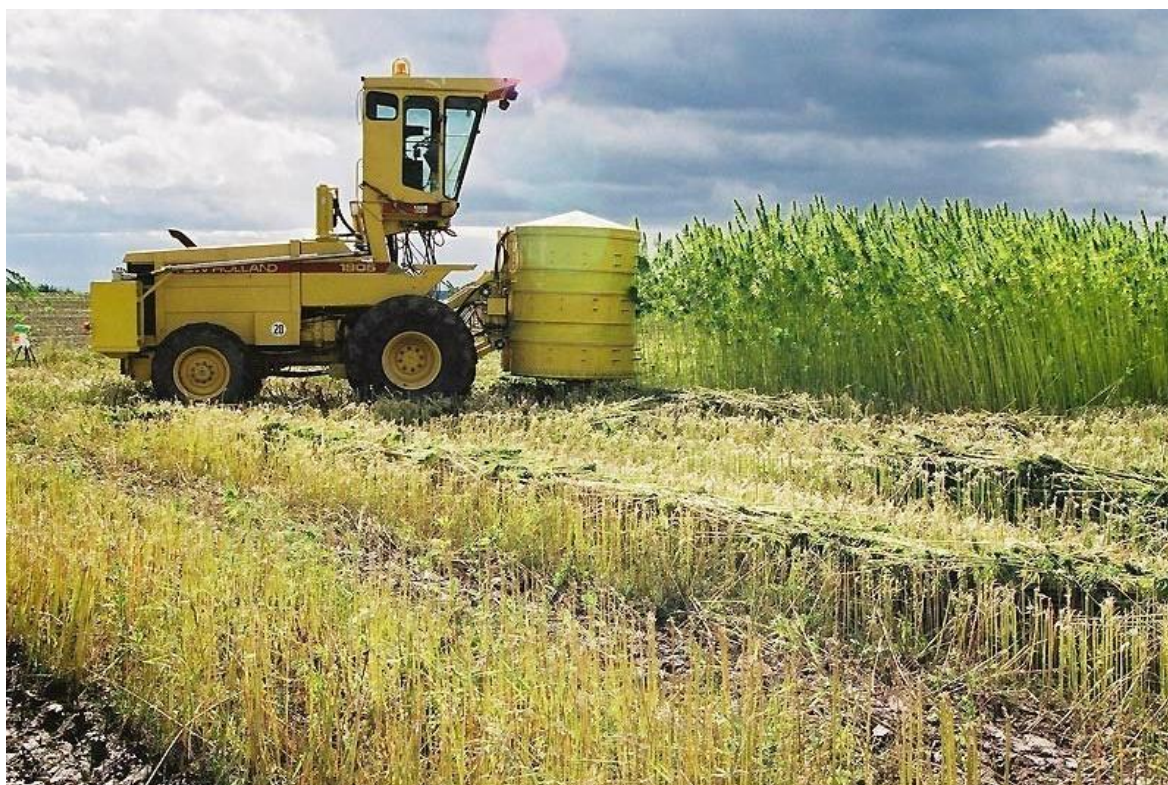
Obrázek 11 Německý stroj Bluecher 02/03 využívaný ke sklizni v Evropě
