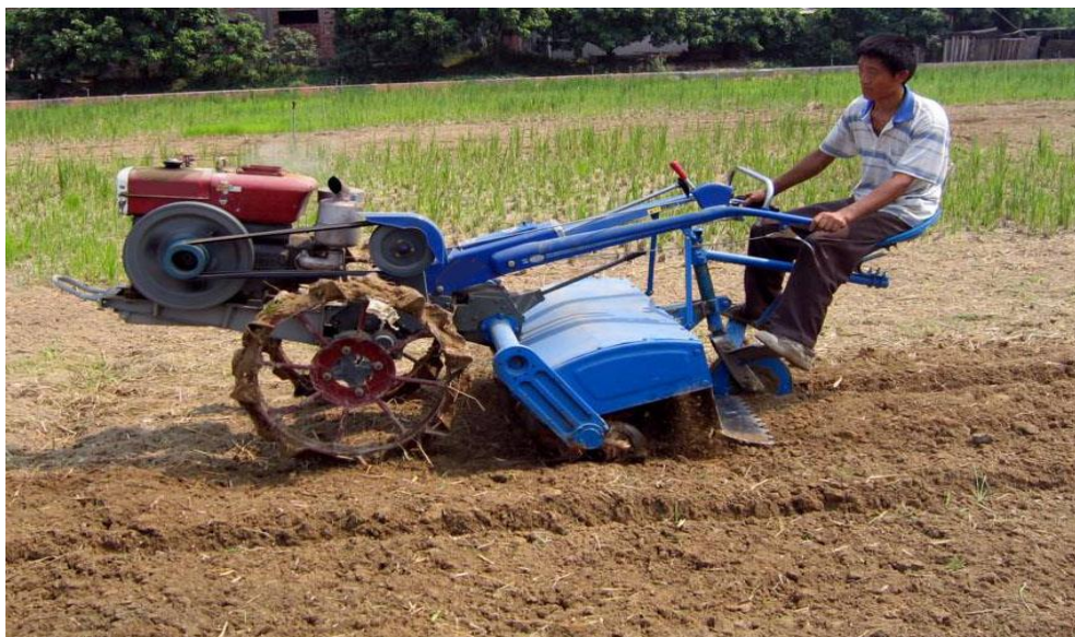
Obrázek 8 Příklad dvoukolového traktoru k upravení půdy.
