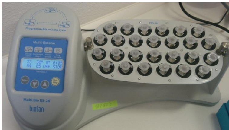
Obr. č. 21 Protřepávání vzorků v přístroji Biosan Multi Bio RS-24 (vlastní foto)
