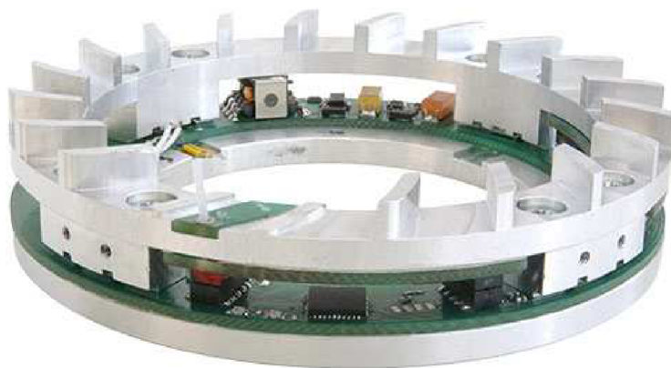
Obr. 13 Bezdrátový monitorovací systém hlídající teplotu ložisek [8]
