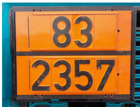
Obr. 6: Ukázka umístění UN Kódu a Kemler Kódu na výstražné tabulce. Zdroj: Autor
