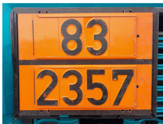
Obr. 6: Ukázka umístění UN Kódu a Kemler Kódu na výstražné tabulce. Zdroj: Autor
