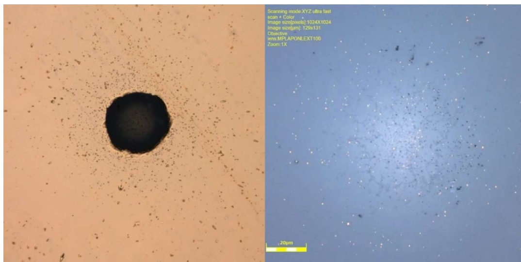
Obrázek 17: Výsledek pro čerpací proud 1600mA při umístění vzorku v ohnisku laserového svazku (50x zvětšeno) [20]
