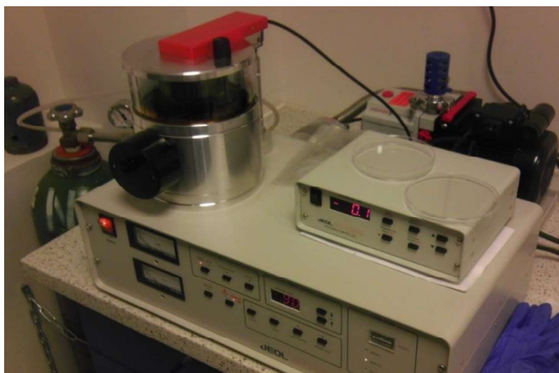
Obrázek 5: Použitá naprašovačka k nanesení zlata na podložní sklíčka [20]
