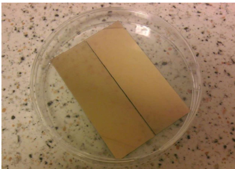
Obrázek 6: Podložní sklíčka s naprašovanou zlatou vrstvou [20]
