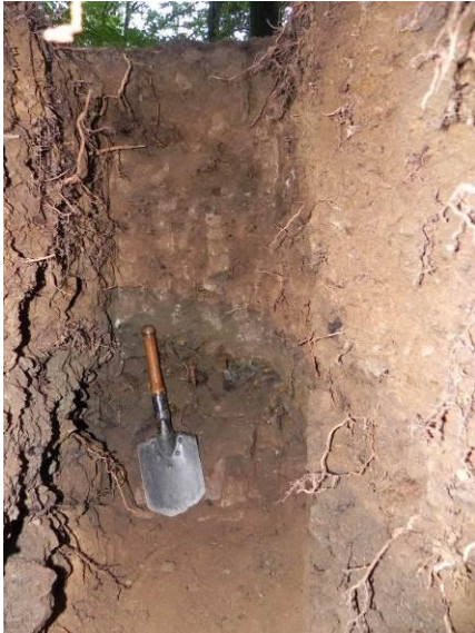
Obr. 22 Fotografie profilu sondy č. 2 s došeda zbarvenou vrstvou hlušiny
