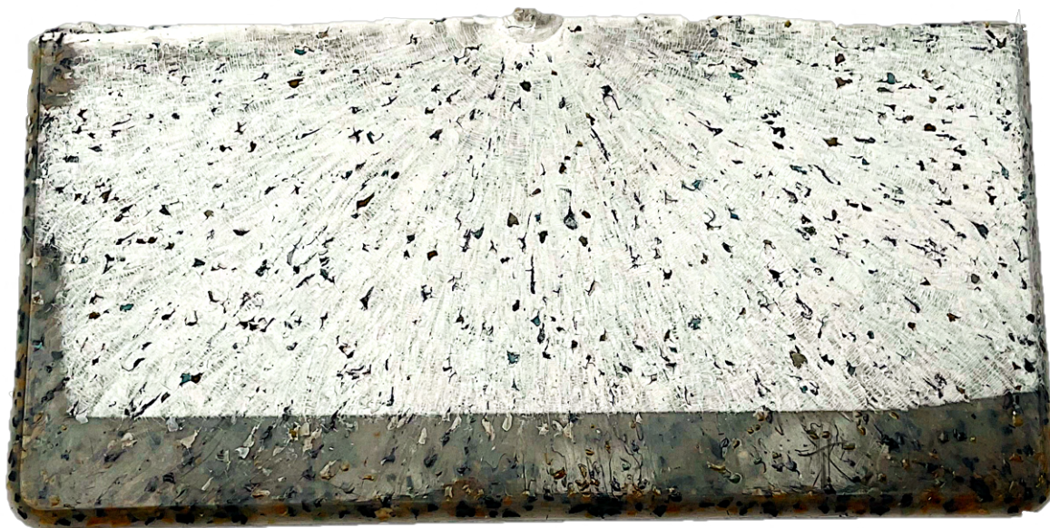
Obrázek 3.40 Vzorek po xenotestu dle PV 3930
