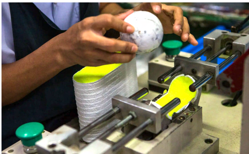
Obrázek 2.8 Lepení povrchu tenisového míče na jádro [18]
