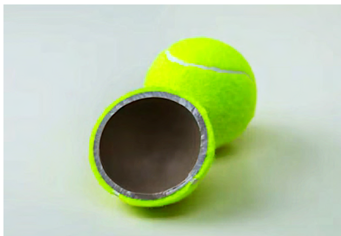
Obrázek 2.2 Řez tlakovým tenisovým míčem
