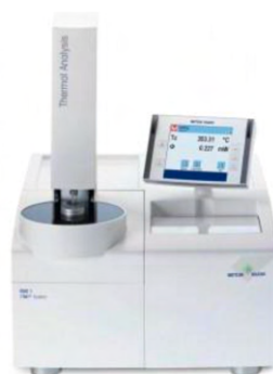
Obrázek 3.10 DSC kalorimetr Mettler Toledo DSC1/700 [58]
