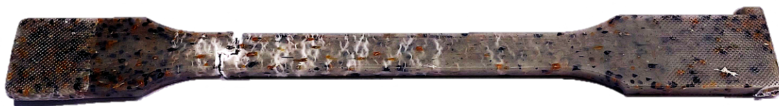
Obrázek 4.3 Zkušební těleso s příměsí recyklátu po tahové zkoušce
