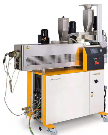
Obrázek 3.16 Kompaundační zařízení Collin Lab-Line ZK 25E [61]
