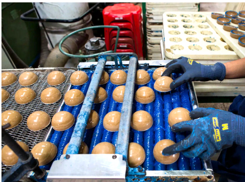
Obrázek 2.4 Výroba dutých polokoulí tenisového míče [18]
