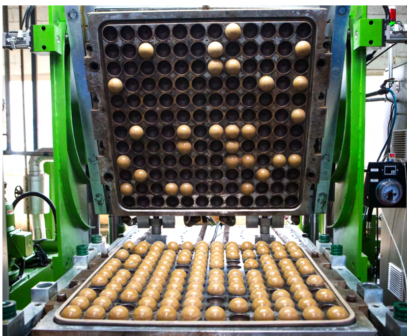
Obrázek 2.5 Výroba dutých koulí tenisového míče [18]
