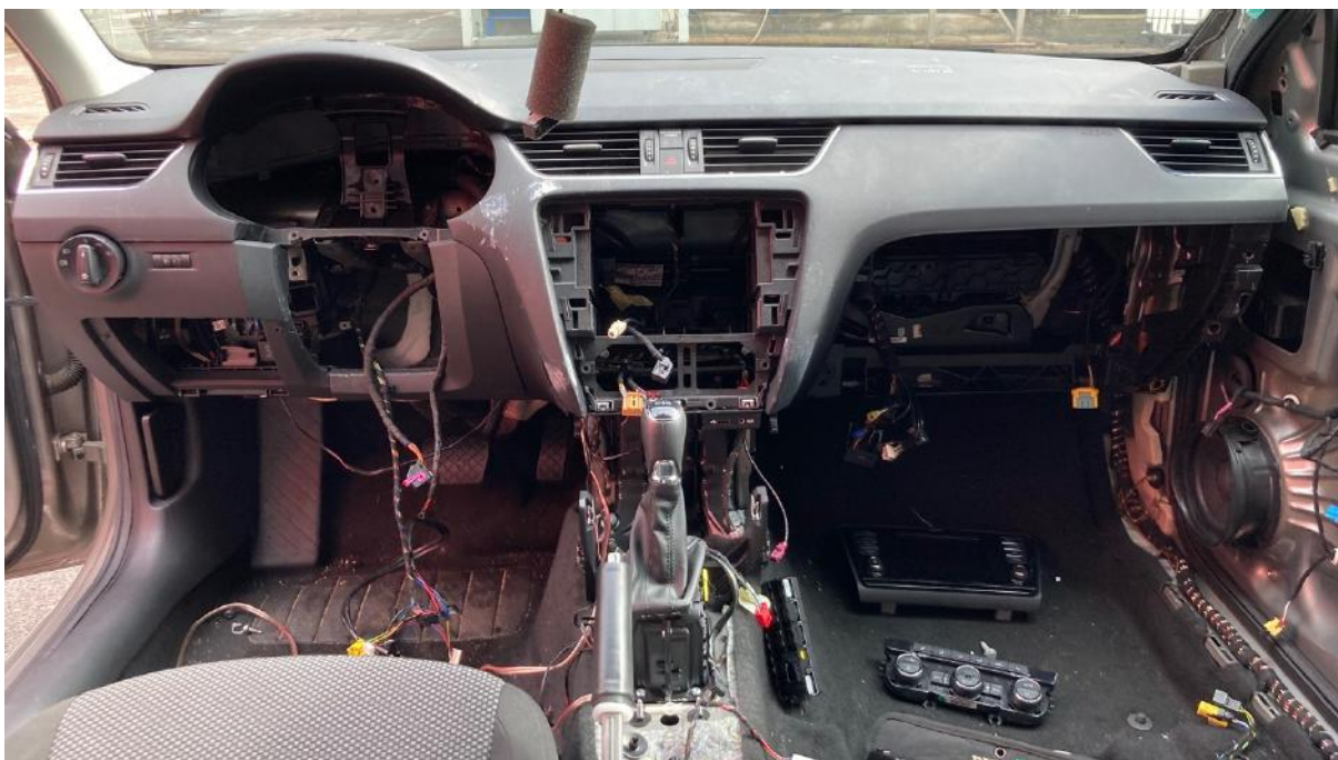
Obr. 4.5 Proces demontáže prístrojovej dosky
