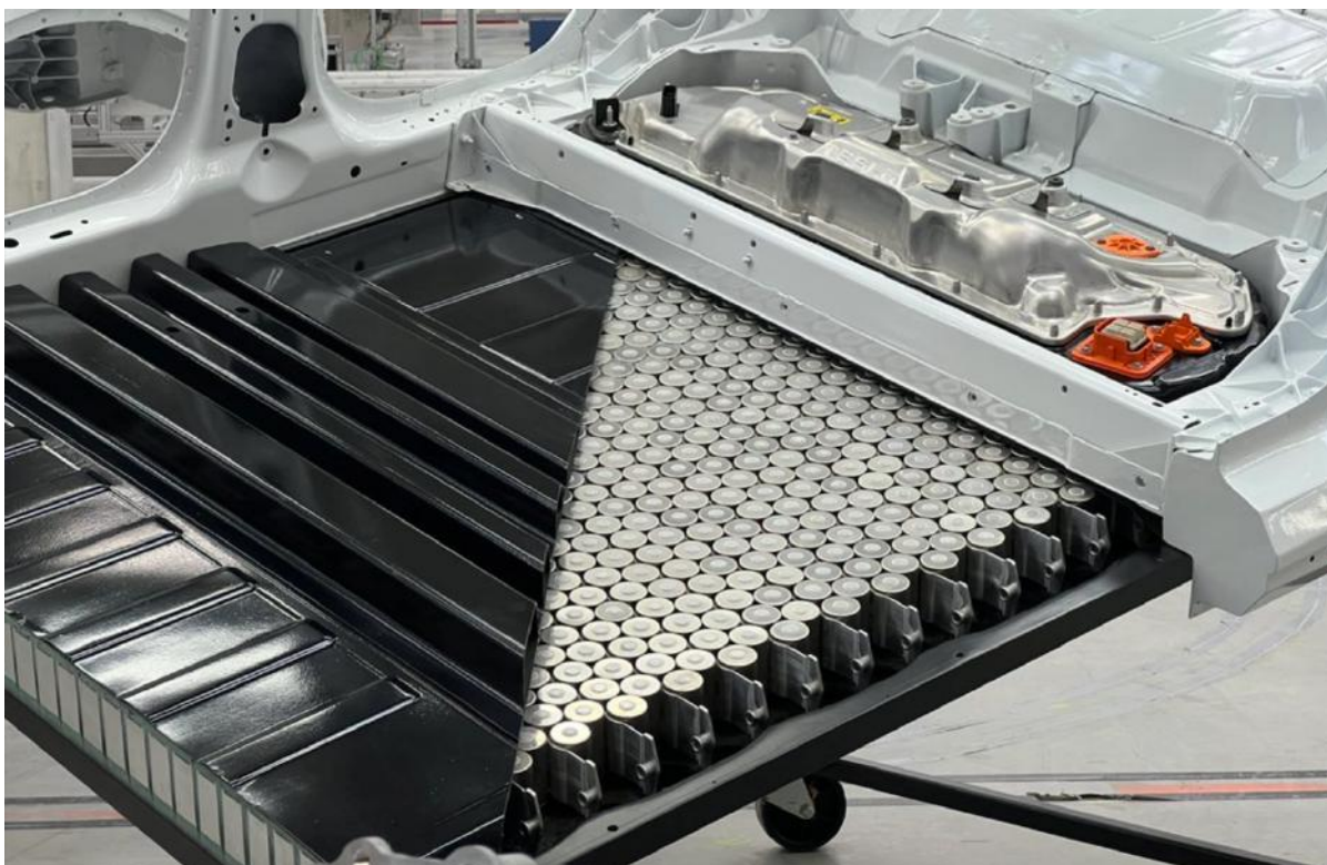
Obr. 2.5 Výrez konštrukčného bloku akumulátora v podvozku vozidla Tesla Model Y, viditeľné jednotlivé články s označením 4680 [53]
