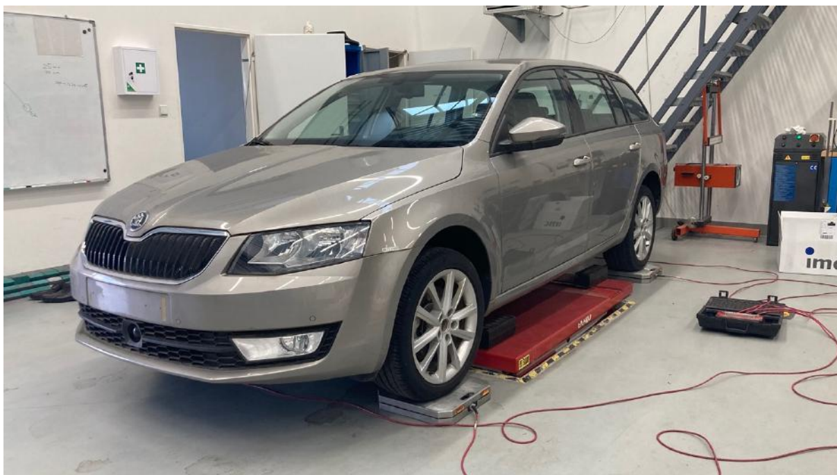
Obr. 4.3 Meranie celkovej hmotnosti vozidla pred zahájením dekompozície
