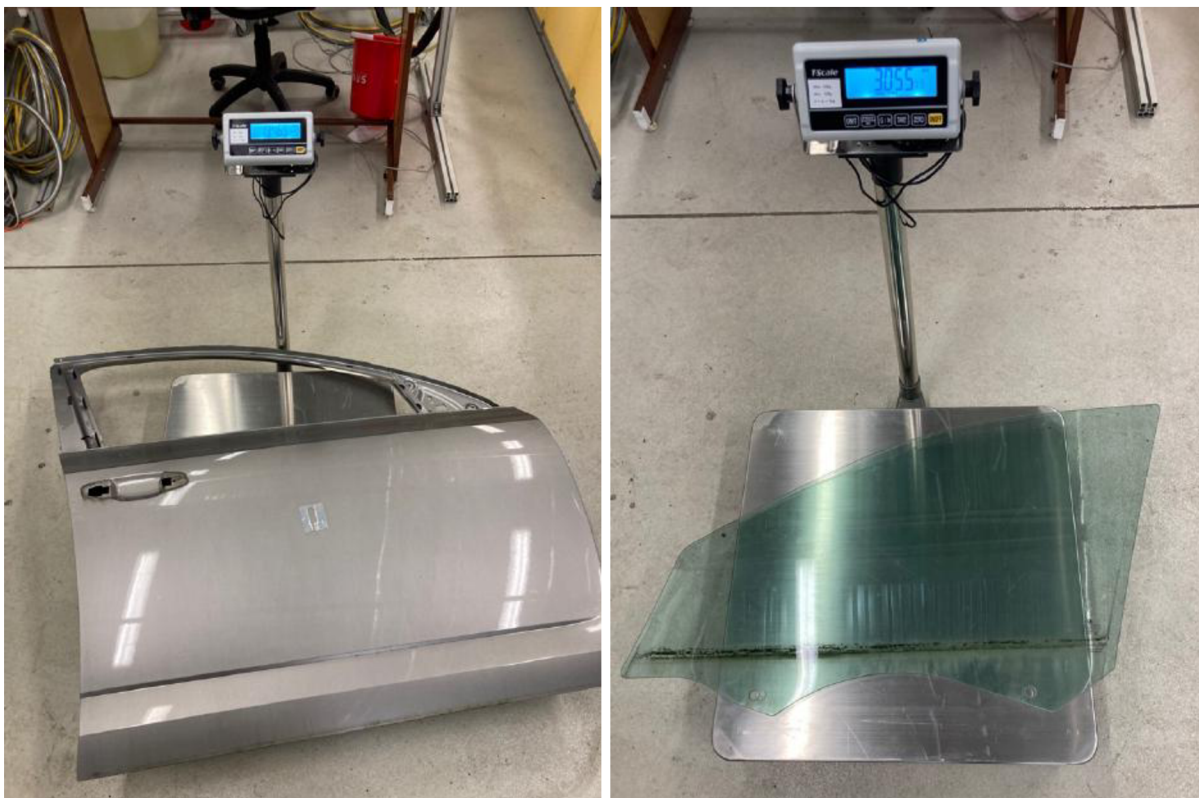
Obr. 4.7 Meranie hmotnosti predných dverí a skla predných dverí
