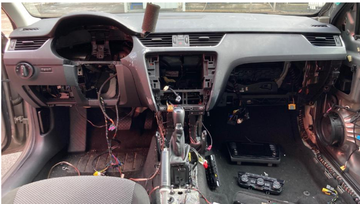
Obr. 4.5 Proces demontáže prístrojovej dosky
