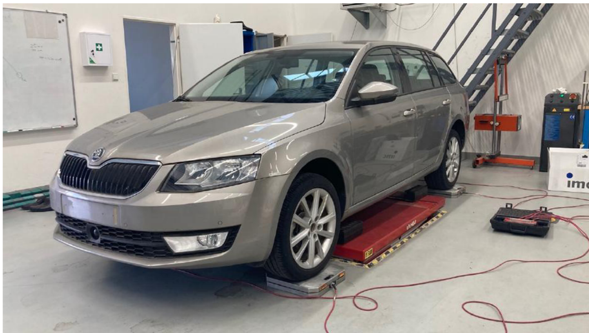
Obr. 4.3 Meranie celkovej hmotnosti vozidla pred zahájením dekompozície
