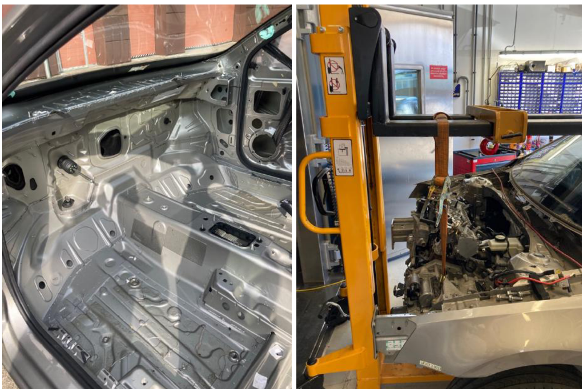
Obr. 4.8 Detailný pohľad na prednú časť kabíny a proces oddelenia motora s prevodovkou od vozidla
