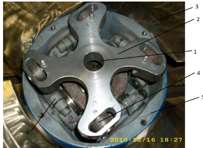
Obr. 3.4 Přestavný kříž oběžného kola [17] 1 - otvor pro ovládací tyč 2 - přestavný kříž 3 - lopatka 4 - táhlo 5 - náboj oběžného kola 6 - páka čepu
