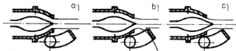
Obr. 2.6 Princip činnosti deflektoru [1]
