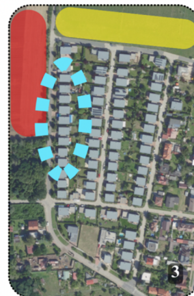
Obr. 14: 1. část postupu výběru nevhodnějšího umístění RZ. Foto 1 Vymezení pozemků developera při výstavbě „Soubor RD Stropnická“. RZ bude umístěna do vymezeného prostoru.; Foto 2 Volba vhodného umístění RZ dle terénních podmínek. Šípky je prezentován směr sklonu terénu (směr odtoku). Ohraničeným prostorem je vyjádřeno nevhodnější umístění RZ.; Foto 3 Centrální předpoklad pro umístění RZ s ohledem na budoucí rozvoj. Červenou plochou jsou vyznačeny pozemky vlastněné developerem s výhledovou výstavbou podobného typu. Žlutou plochou je vyznačen prostor určený pro výstavbu vzdělávacího střediska. (zdroj schématu: Autor, 2024; ortofoto: ČÚZK, ©2024c)
