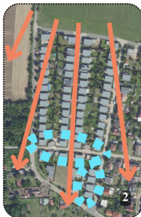
Obr. 14: 1. část postupu výběru nevhodnějšího umístění RZ. Foto 1 Vymezení pozemků developera při výstavbě „Soubor RD Stropnická“. RZ bude umístěna do vymezeného prostoru.; Foto 2 Volba vhodného umístění RZ dle terénních podmínek. Šípky je prezentován směr sklonu terénu (směr odtoku). Ohraničeným prostorem je vyjádřeno nevhodnější umístění RZ.; Foto 3 Centrální předpoklad pro umístění RZ s ohledem na budoucí rozvoj. Červenou plochou jsou vyznačeny pozemky vlastněné developerem s výhledovou výstavbou podobného typu. Žlutou plochou je vyznačen prostor určený pro výstavbu vzdělávacího střediska. (zdroj schématu: Autor, 2024; ortofoto: ČÚZK, ©2024c)
