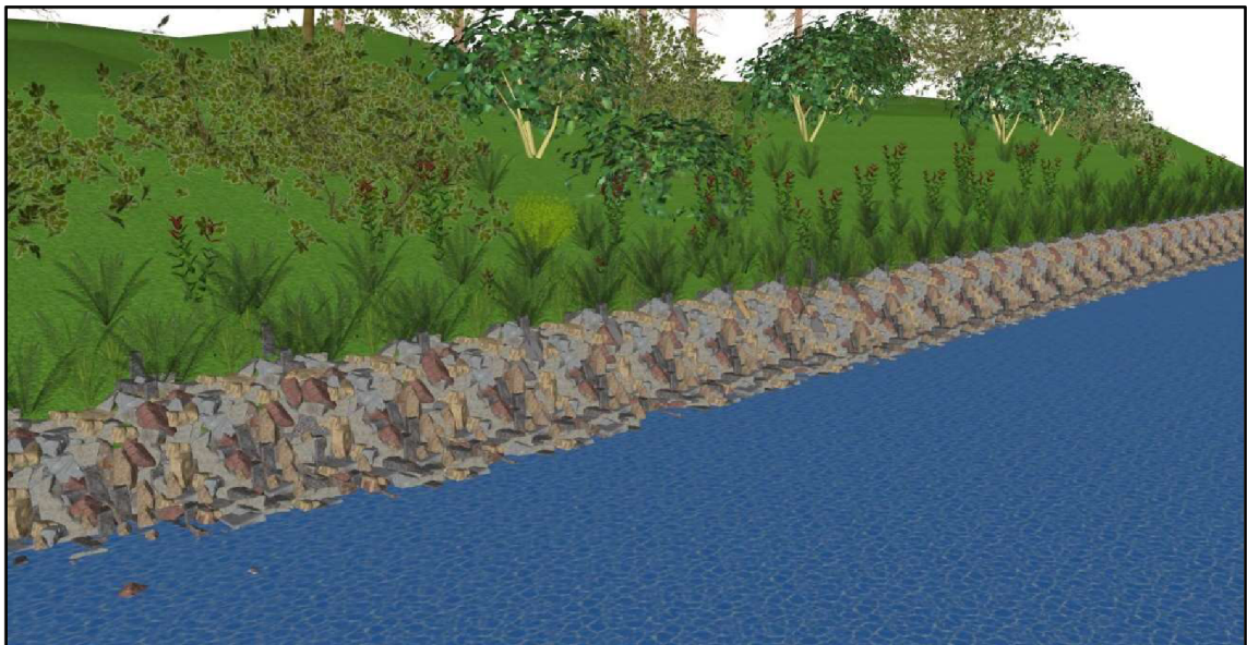
Obr. 3.7 Vizualizace kamenné stabilizační paty
