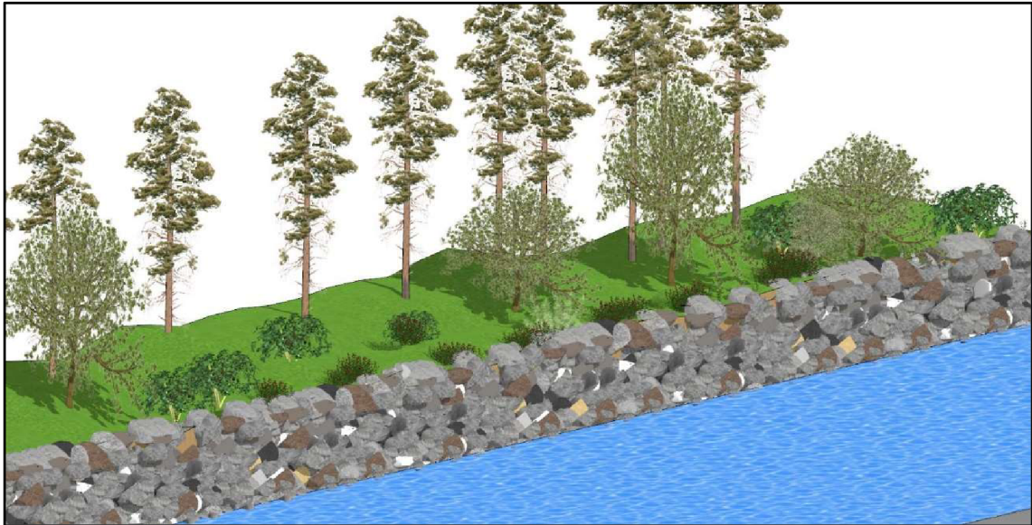
Obr. 3.6 Vizualizace stabilizace lomovým kamenivem
