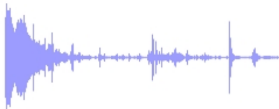
Obr. 1.16: 1. sekunda změny akustického tlaku při rozbití skleněné tabule
