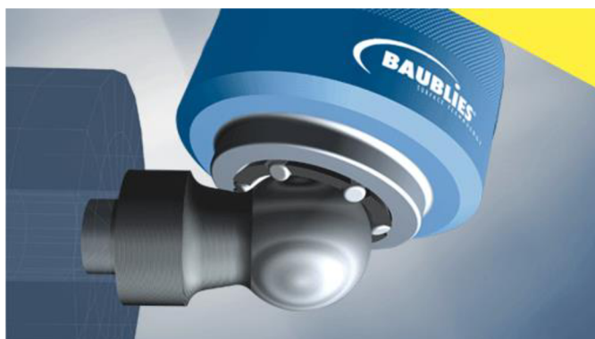
Obr. 31 Válečkování kulové hlavy [26].
