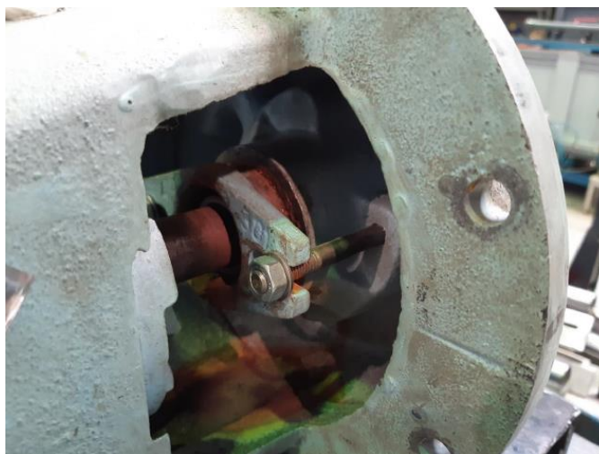
Obrázek 9-4 Víko čerpadla, sloužící k utěsnění média při utažení napětím \sigma_{v1} .
