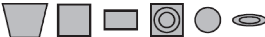
Obrázek 4-4 Pruřezy těsnící šňůr [5].
