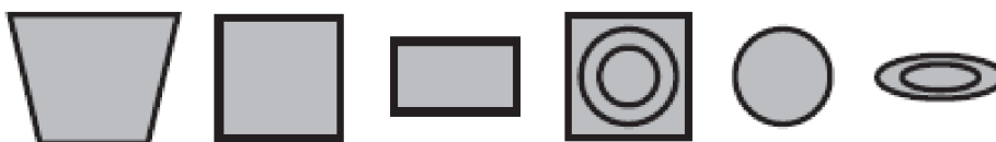
Obrázek 4-4 Průřezy těsnící šňůr [5].
