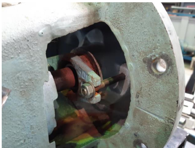
Obrázek 9-4 Víko čerpadla, sloužící k utěsnění média při utažení napětím \sigma_{v1} .
