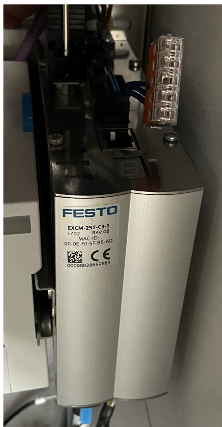
Obrázek 3.3: Kontrolér pro ovládání pohonu H-Portalu
