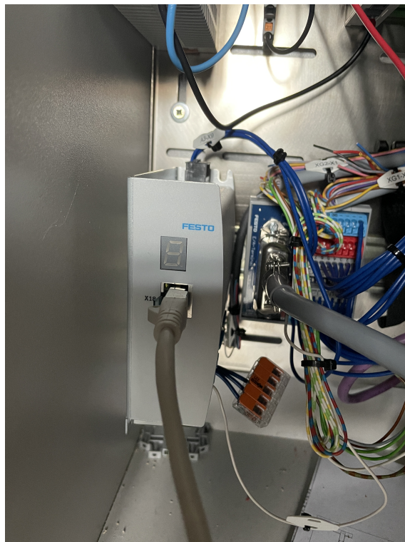
Obrázek 3.4: Kontrolér pro ovládání krokových motorů ramena
