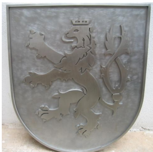
Obr. 3.10 Umělecká tvorba pomocí technologie frézování vodním paprskem [47].
