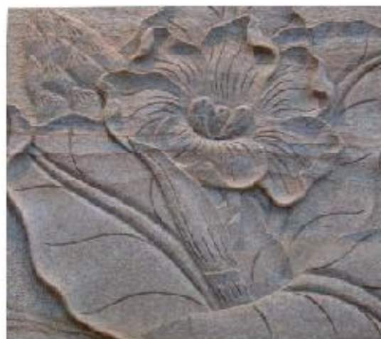
Obr. 3.8 Ukázka gravírování reliéfů na mosaz a kámen technologií AWJ [16].
