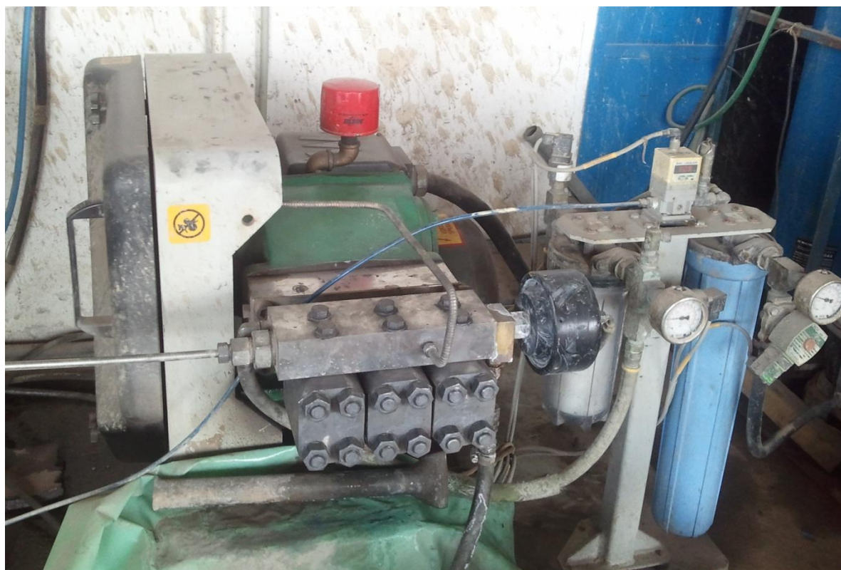
Obr. 4.2 Systém hyplexového čerpadla ve firmě Vy-TECH.
