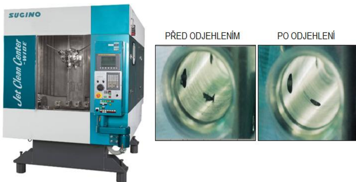
Obr. 6.4 Odjehlovací vodní centrum firmy SUGINO. [49]
