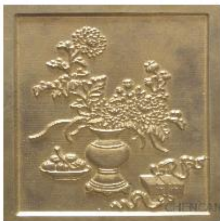
Obr. 3.8 Ukázka gravírování reliéfů na mosaz a kámen technologií AWJ [16].
