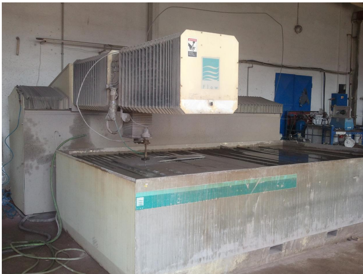
Obr. 4.1 Strojní zařízení MACH 3 pro řezání vodním paprskem ve firmě Vy-TECH.
