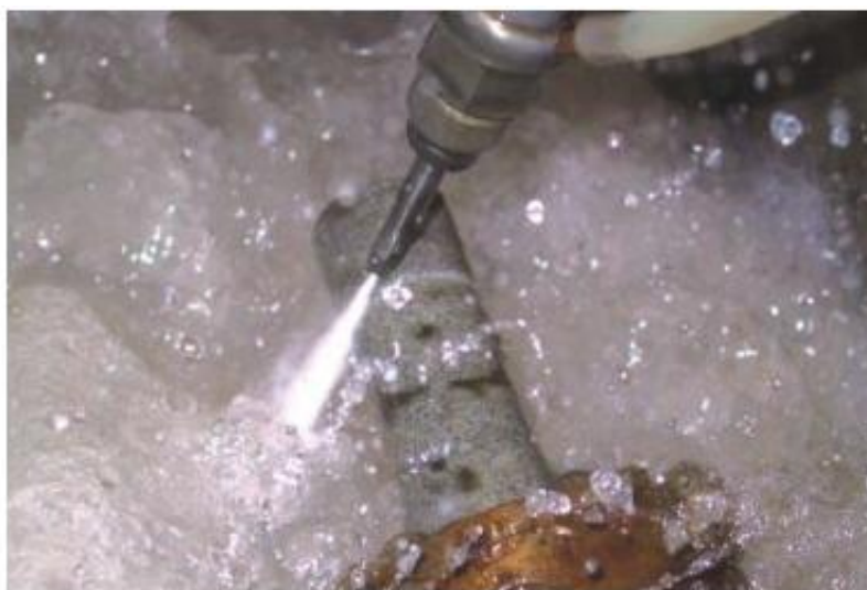
Obr. 3.4 Ukázka soustružení pískovce technologií AWJ [43].
