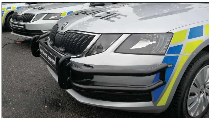
Obr. č. 22 – Vytlačovací rám policejních vozidel [11]
