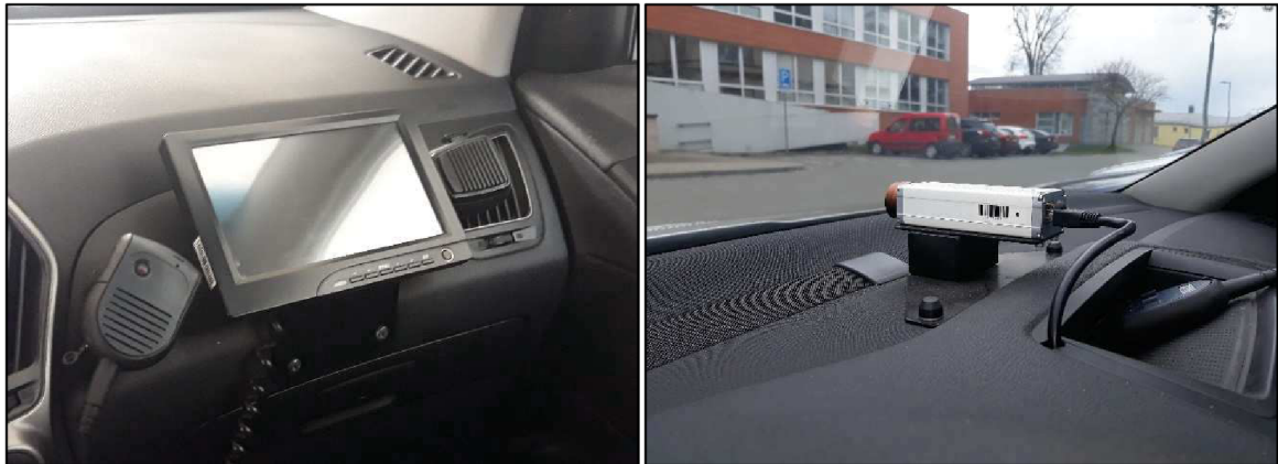
Obr. č. 30 – Monitor lokalizačního záznamového zařízení + umístění přední kamery vozidla
