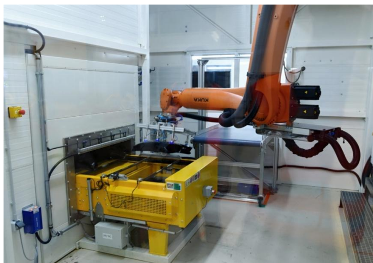
Obr. 1.10 Odkládání výlisku robotem na dopravník.
