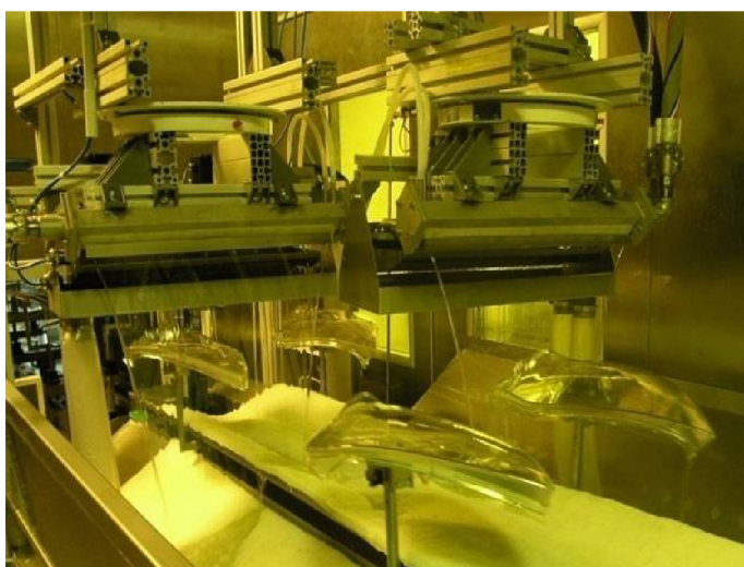
Obr. 1.15 Lakování výlisku poléváním.
