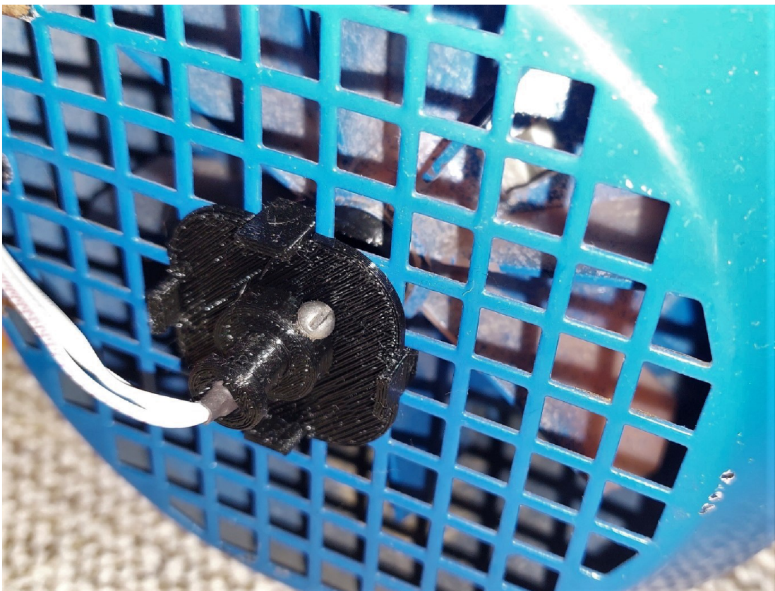
Obr. 4.2: Držák pro Hallův snímač na motoru
