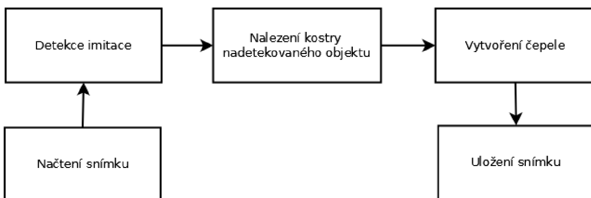
Obrázek 3: Blokové schéma algoritmu pro zpracování jednoho snímku
