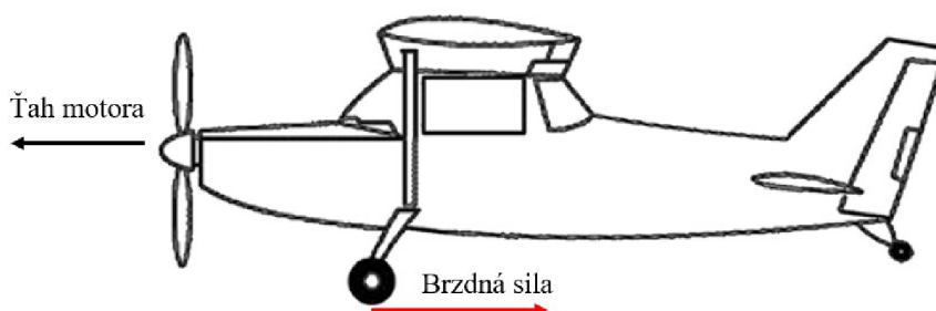
Obrázok 24. Ťah a trecia sila pôsobiaca pri štarte (upravené)[19]
