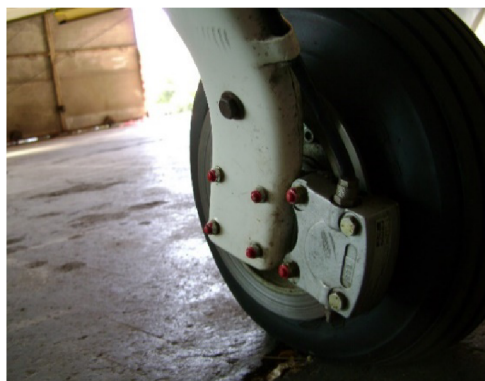
Obrázok 4 Jednoduchá kotúčová brzda
