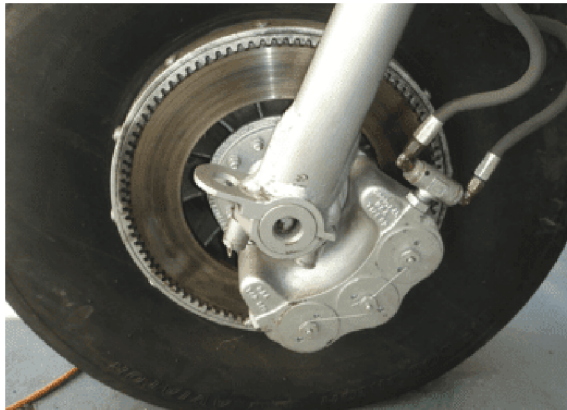
Obrázok 9. Kotúčová brzda s plávajúcim diskom [5]
