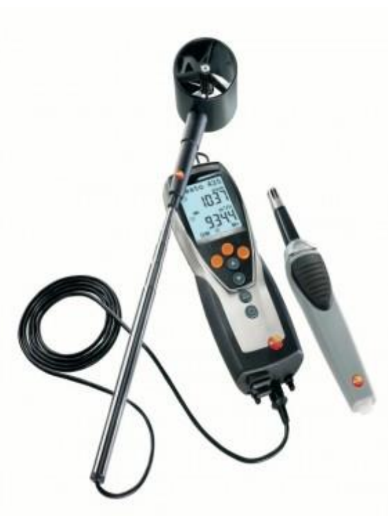
Obrázek č. 6 – Anemometr Testo 435,
