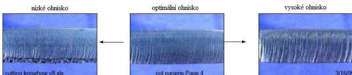
Obr. 18 Závislost polohy ohniska na jakosti řezné plochy
