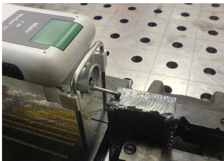
Obr. 38 Měření hodnot R_a , R_z , R_{sm}
