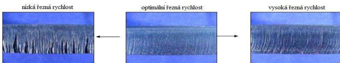
Obr. 20 Závislost řezné rychlosti na jakosti řezné plochy
