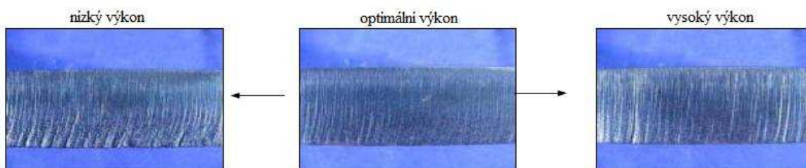
Obr. 19 Závislost výkonu laseru na jakosti řezné plochy
