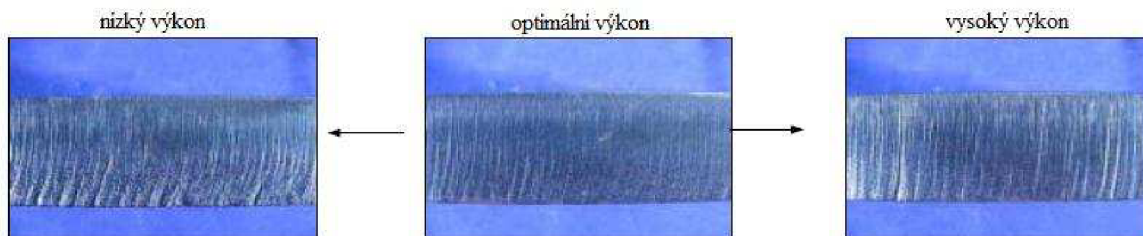
Obr. 19 Závislost výkonu laseru na jakost řezné plochy
