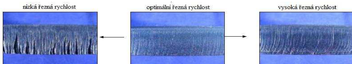
Obr. 20 Závislost řezné rychlosti na jakost řezné plochy
