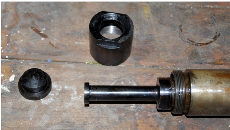
Obr. 35 Effervescentní atomizér použitý při zkouškách
