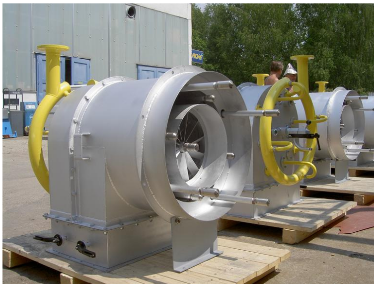
Obr. 11 Kombinovaný výkonový hořák VUCHZ HPN-Te5K ( www.vuchz.cz )
