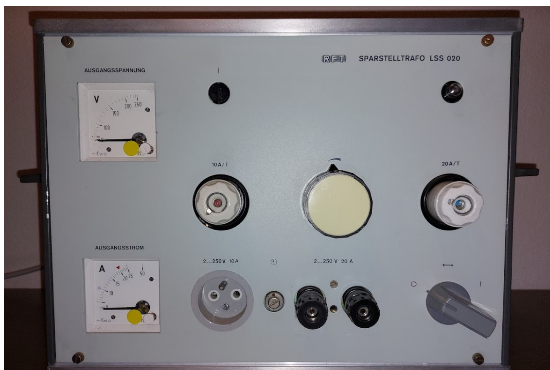
obr. č. 40 Autotransformátor použitý k testu regulace otáček motorku. Archív autora.
