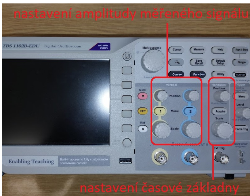
obr. č. 47 Čelní pohled na ovládací panel běžného digitálního osciloskopu. V rámečcích jsou označeny základní prvky pro vertikální (amplituda) a horizontální (časová základna) nastavení zobrazení měřeného signálu. Archiv autora.
