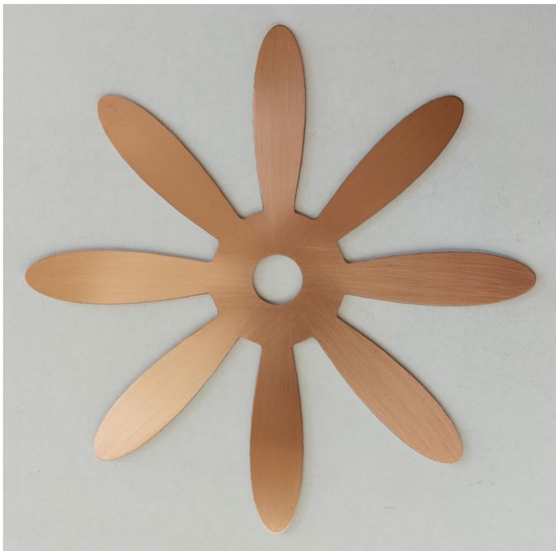
obr. č. 5 Osmilistá stacionární měřicí elektroda navržená a vyrobená v rámci této práce. Archiv autora.
