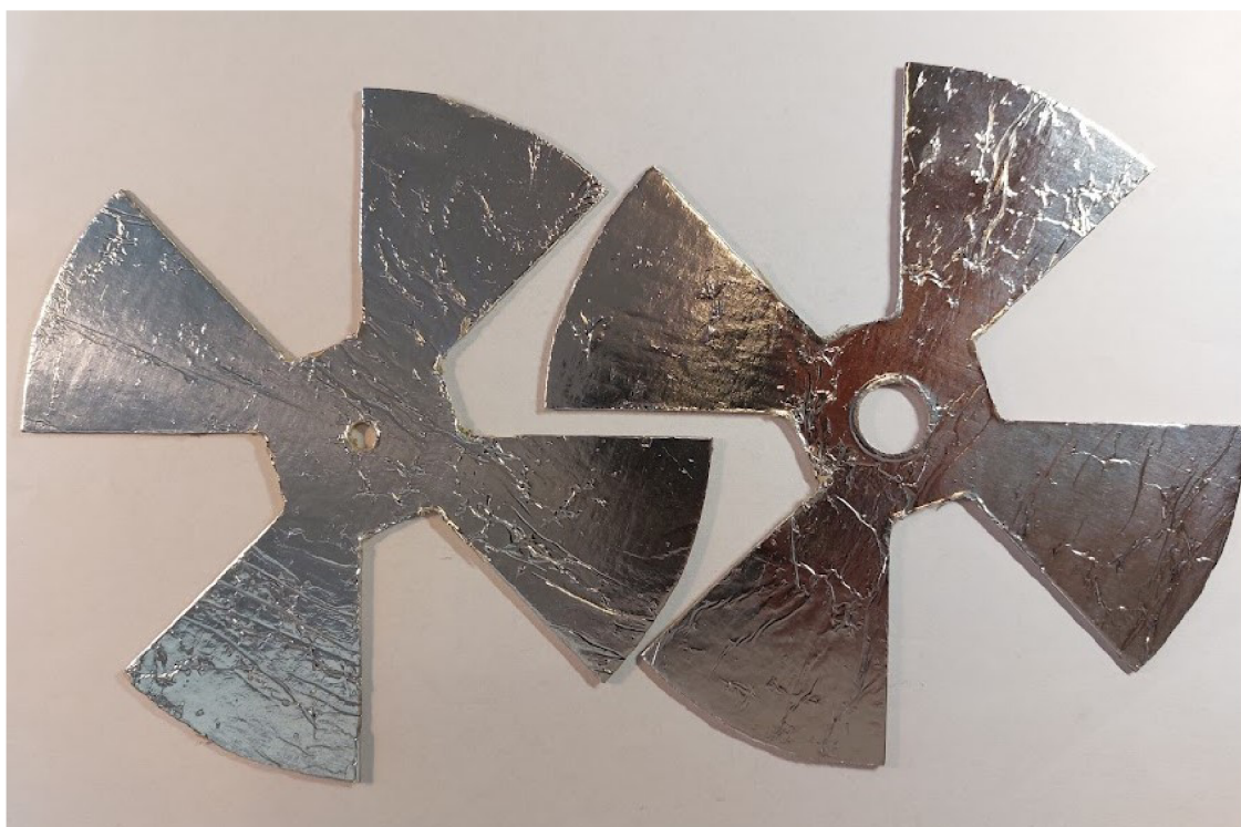
obr. č. 13 Čtyřlístá elektroda. Na obrázku vlevo rotační stínící elektroda, na obrázku vpravo stacionární měřící elektroda. Archív autora.
