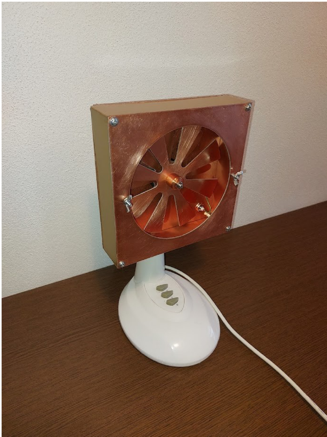
obr. č. 37 Celkový pohled na kompletní VN voltmetr. Na podstavci jsou umístěna tři tlačítka. První tlačítko nejdále od nosného dílu podstavce slouží pro vypnutí, druhé tlačítko spíná snížené otáčky, třetí tlačítko nejbližší k nosnému dílu podstavce spíná maximální otáčky motorku. Archív autora.
