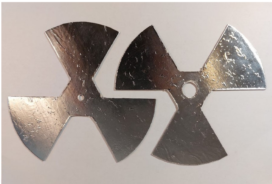
obr. č. 10 Třílistá elektroda. Na obrázku vlevo rotační stínící elektroda, na obrázku vpravo stacionární měřicí elektroda. Archív autora.
