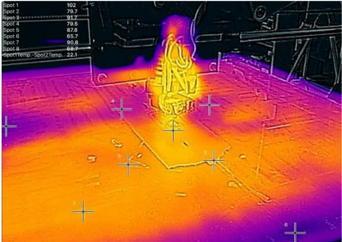
Obrázek 15 Nekonzistentní vyhřívání tiskové podložky (Douglas, 2019)
