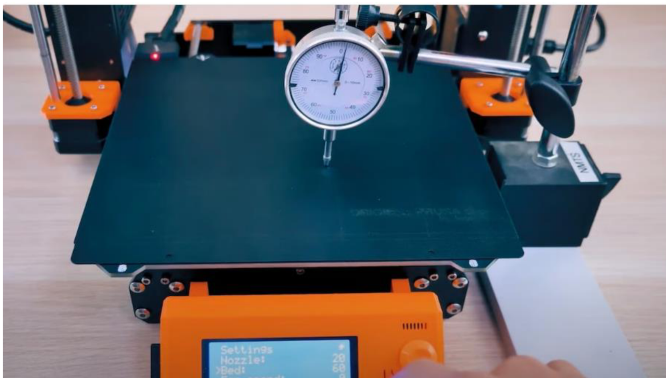
Obrázek 14 Vyhřívání podložka (Douglas, 2019)
