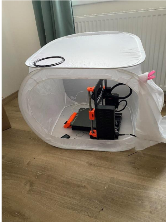
Obrázek 22 Zakrytování 3D tiskárny
