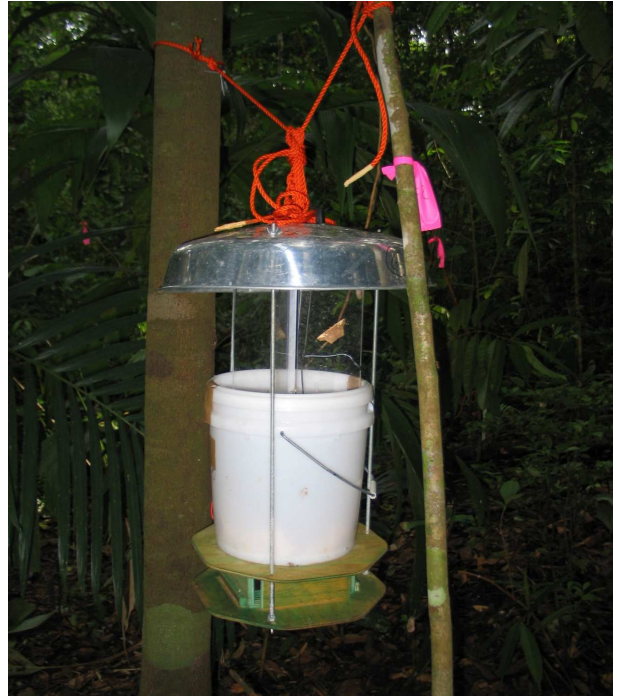
Obr. 13 Světelná past pro použití v korunách (N. Baiben).
