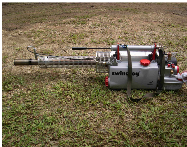
Obr. 10 Příklad přístroje k výrobě mlhy s insekticidem ("fogging machine"). Na obrázku model Swingfog (S. Ribeiro).
