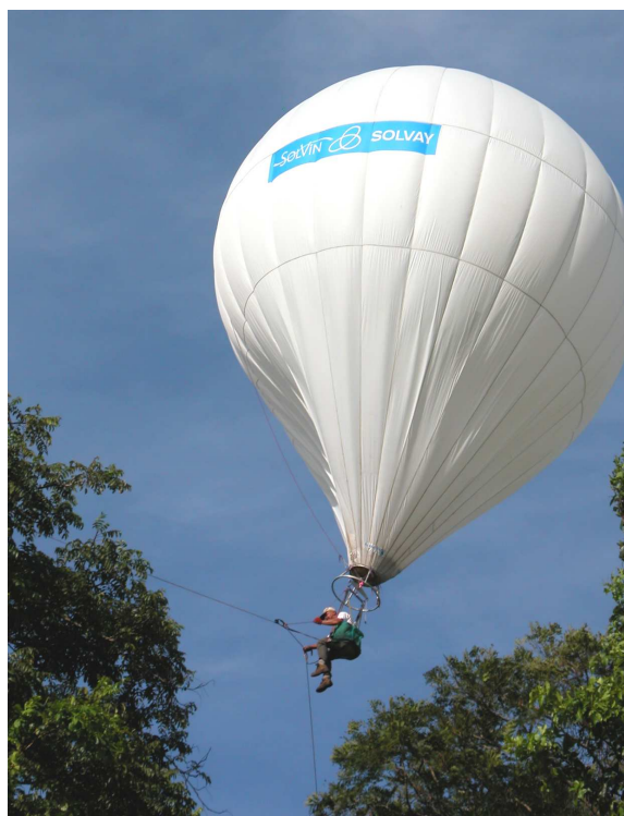
Obr. 9 Tzv. "treetop bubble", balon naplněný heliem s jednou osobou v sedáku. Z obrázku je patrný kabel natažený přes koruny stromů (J. Orivel).
